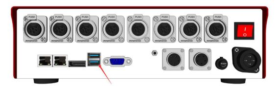
5. 打開 monster 插入 U 盤之後,可以看到 Monster 液晶螢幕字樣由 "UPGRADING..." 變為 "RESTARTING...", 說明系統已經更新成功,正在重啟,重啟時間約一分鐘。
