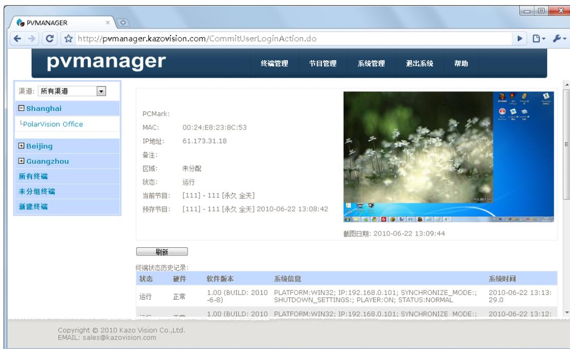
WEB 管理端会每隔一定的时间自动取回终端上的显示信息，以供管理员监控和掌握终端播放信息。同时，在页面下方也会实时的反馈该终端是统计信息，供管理员诊断终端的播放情况。
